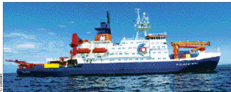
Armé par l'Institut Alfred Wegener (AWI), le Polarstern est un brise-glace à double coque, opérationnel jusqu'à moins 50°. Long de 118 m et calant 11,21 m, il peut traverser des blocs de glace d'1,50 m d'épaisseur.
