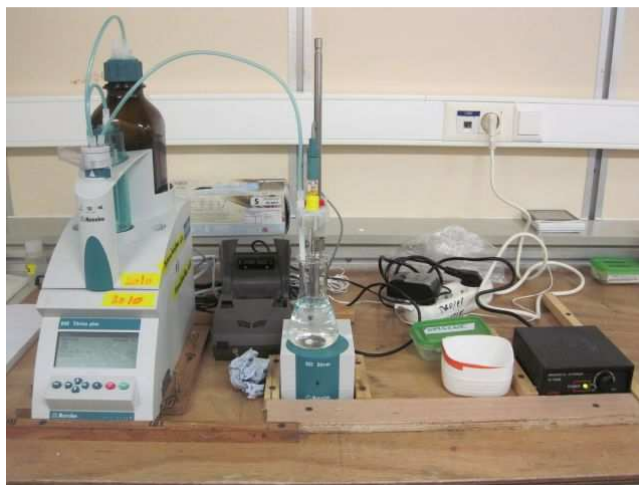
(Installation, du poste d'analyse d'oxygène dissous - laboratoire propre – bâbord – pont C)
