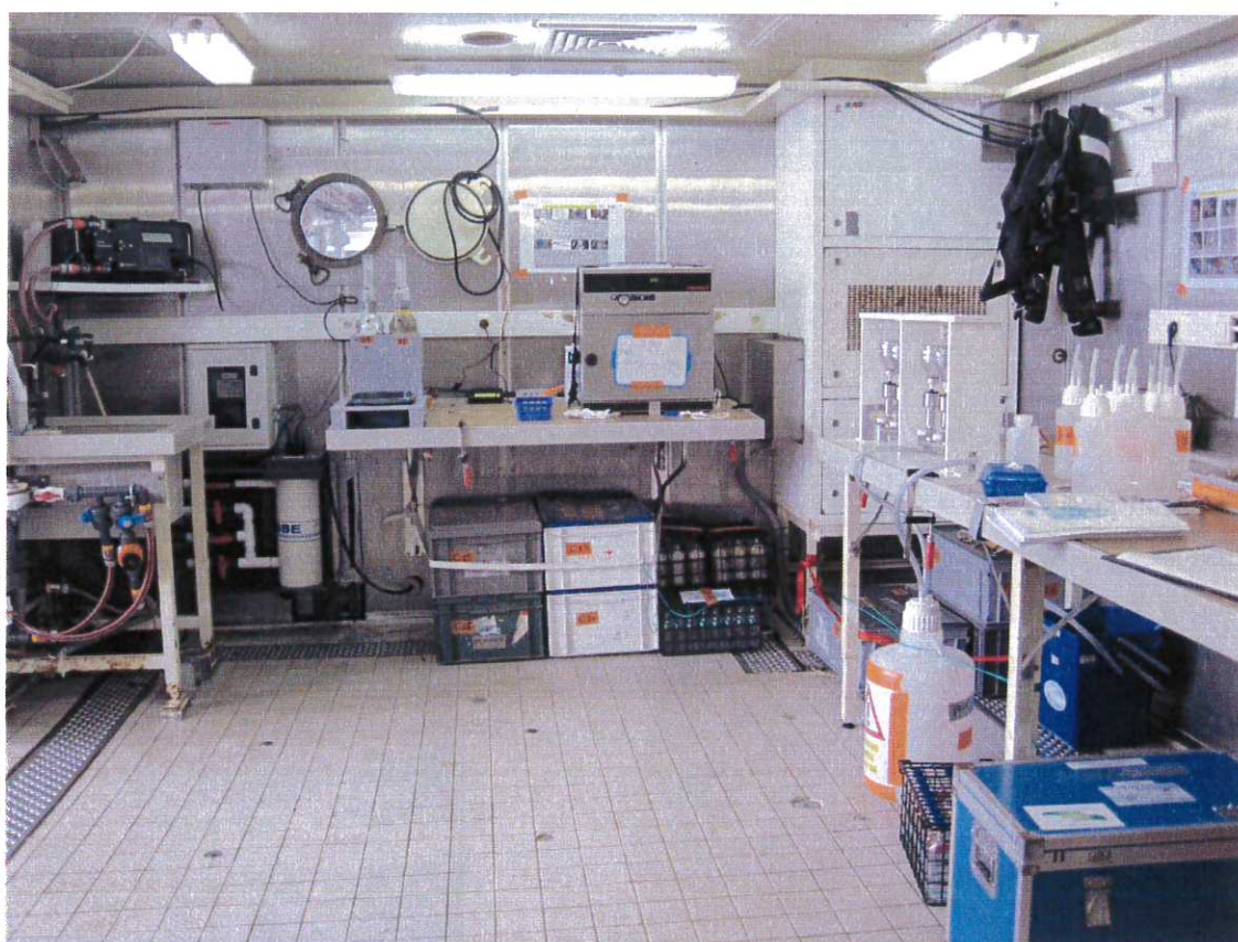
(Installation, des postes : de filtration, des réactifs oxygène et de l'étuve pour pasteurisation dans le laboratoire humide – tribord – pont C)
