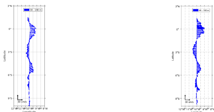
Figure 32 : Comparaison des tracés sous forme des vecteurs des vitesses absolues du courant moyennées de l'OS38 entre 50m et 200m sur la radiale 10°W pendant PIRATA-FR30 (à gauche) et PIRATA-FR29 (à droite).
