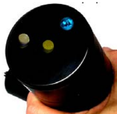
Capteur optique miniaturisé : fluorimètre, turbidimètre, diffusiomètre (Wetlab ECO-PUCK)
