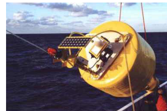
A gauche, GEOSTAR et le "mobile docker", ROV spécialisé utilisé pour son déploiement. Ci-dessus la bouée utilisée pour les liaisons satellite avant son mouillage.
