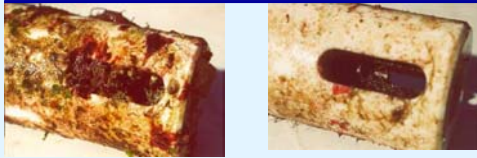
Conductimètre non protégé et protégé après 130 j
