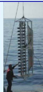
Préleveur étagé pour mesurer des gradients verticaux
