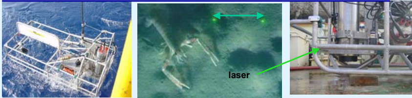
Mesure de tailles, par laser sur engin remorqué
