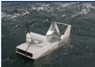
Poisson remorqué pour mesures hydrologiques
