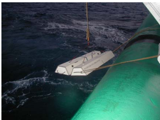
Mise à l'eau d'un flotteur (sarcophage)
