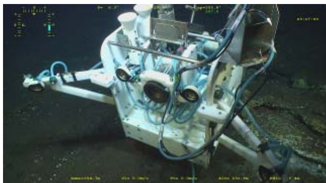
Fig 4. Tempo est constitué d'une caméra vidéo HD, de 4 projecteurs à LED, d'un analyseur in situ Chemini pour l'analyse du fer et d'une optode qui mesure la température et la concentration en oxygène dissous.
