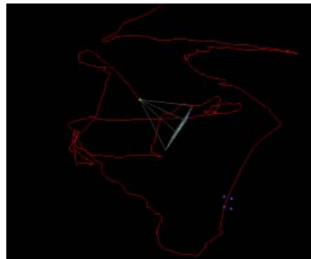
Fig 9. Vue de la trajectoire de la caméra en 3D par rapport à la mire de calibration (représentée par des points bleus)
