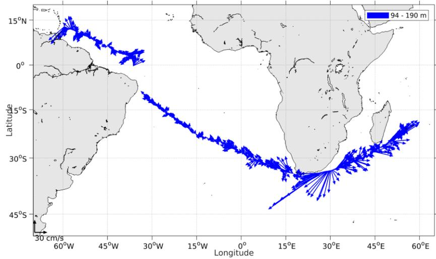
Figure 12- Vecteurs du courant de la section 1 de 100 à 200 m
