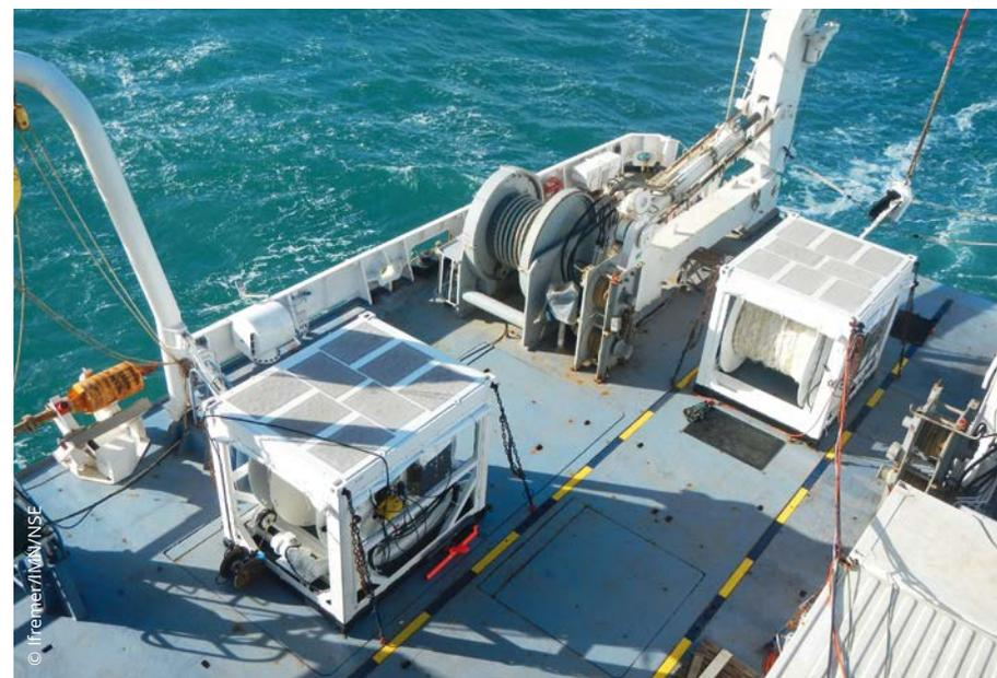
Déploiement de l'équipement sismique SIS 2 sur L'Atalante
