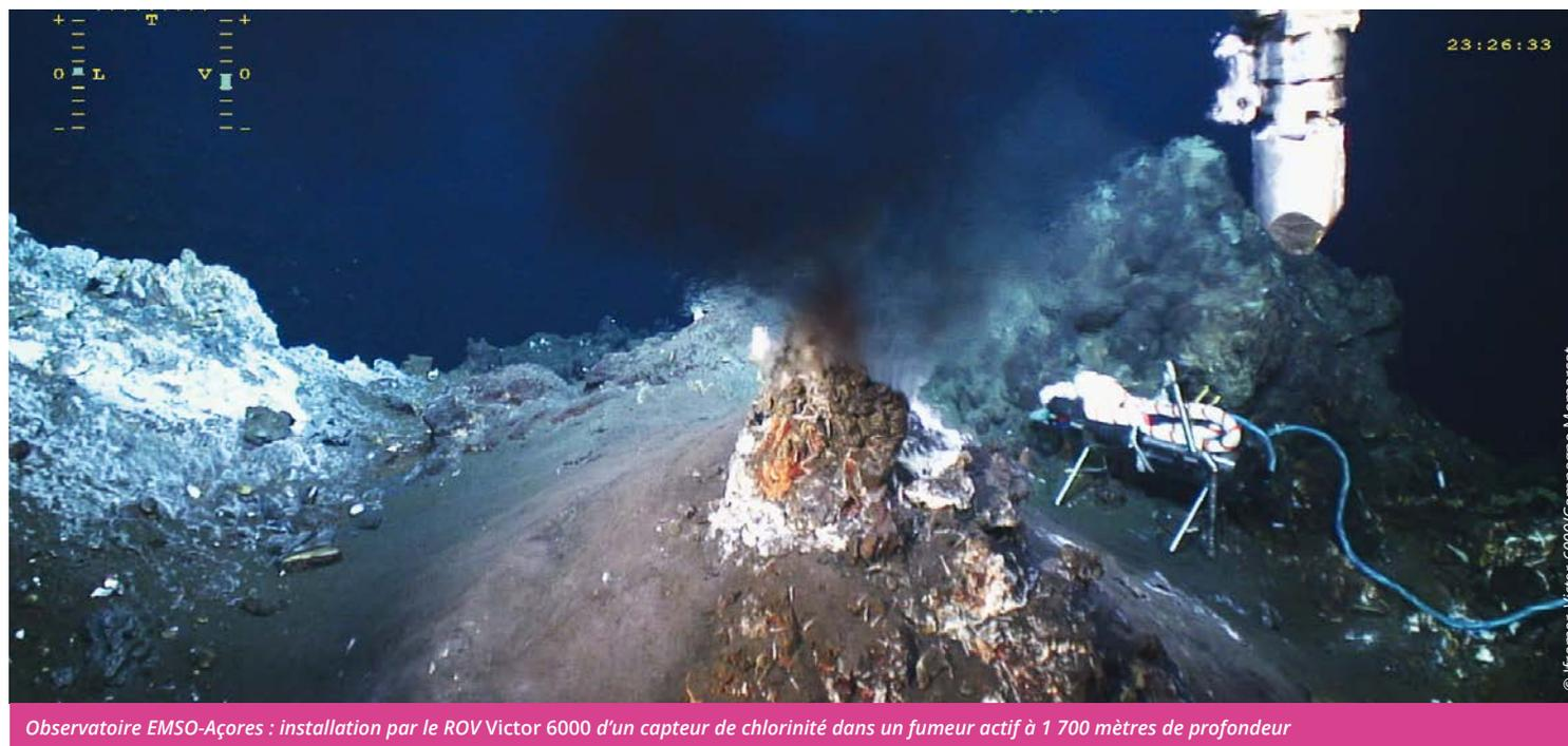
Observatoire EMSO-Açores : installation par le ROV Victor 6000 d'un capteur de chlorinité dans un fumeur actif à 1 700 mètres de profondeur
