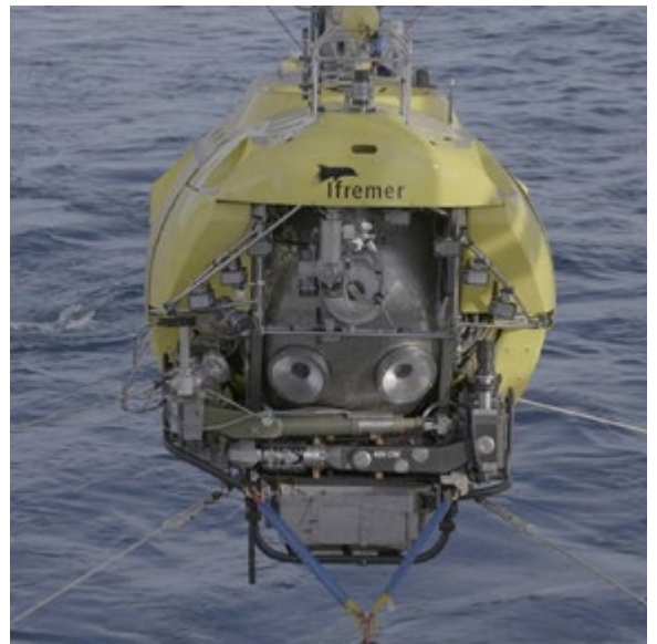
Nouvelle face avant du Nautille avec de nouveaux projecteurs à LED © Ifremer
