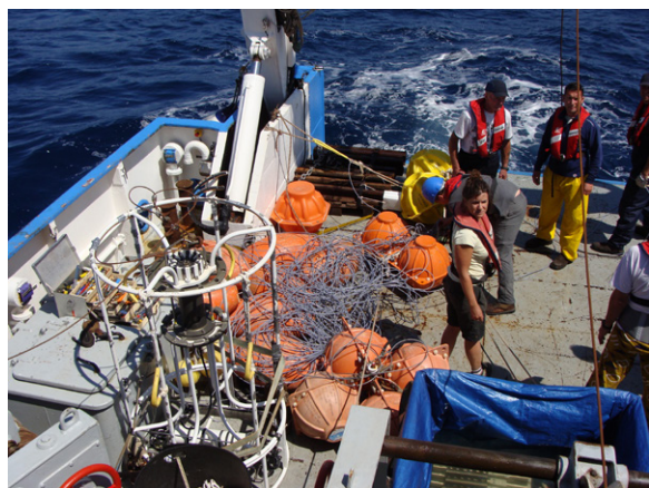
Récupération d'une ligne de mouillage sur le Téthys © Xavier Durrieu de Madron/ CEFREM/CNRS Photothèque
