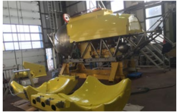
Assemblage du Nautille en dernière phase du Grand Carénage. © Ifremer
