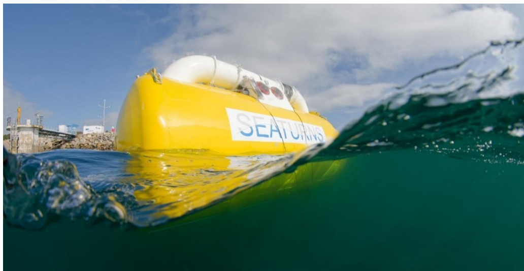
Le prototype, long de 3,6m pour 1,5m de diamètre, restera 10 mois sur le site d’essai de Sainte-Anne du Portzic. – Ifremer, Olivier DUGORNAY
