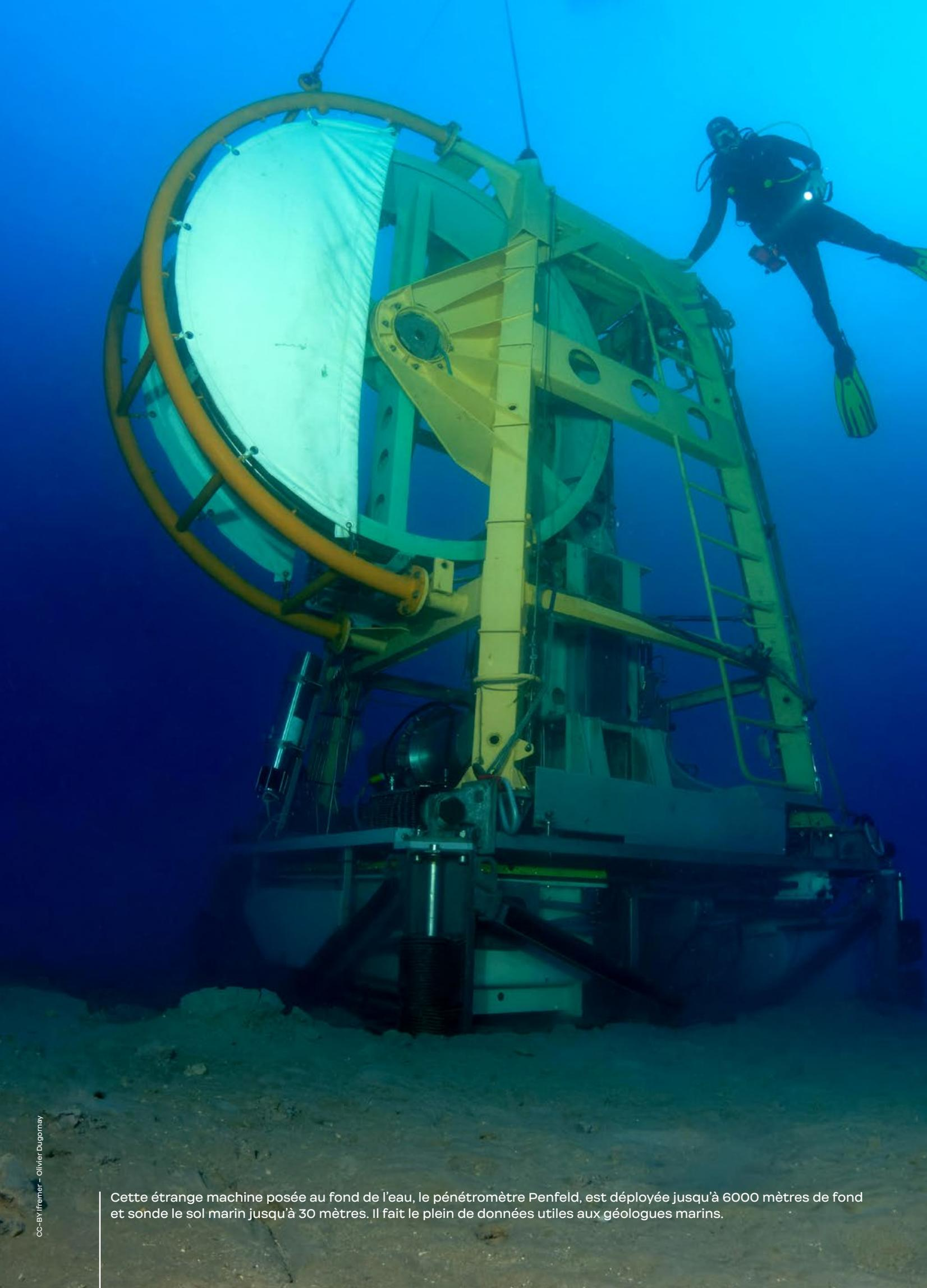
Cette étrange machine posée au fond de l'eau, le pénétromètre Penfeld, est déployée jusqu'à 6000 mètres de fond et sonde le sol marin jusqu'à 30 mètres. Il fait le plein de données utiles aux géologues marins.
