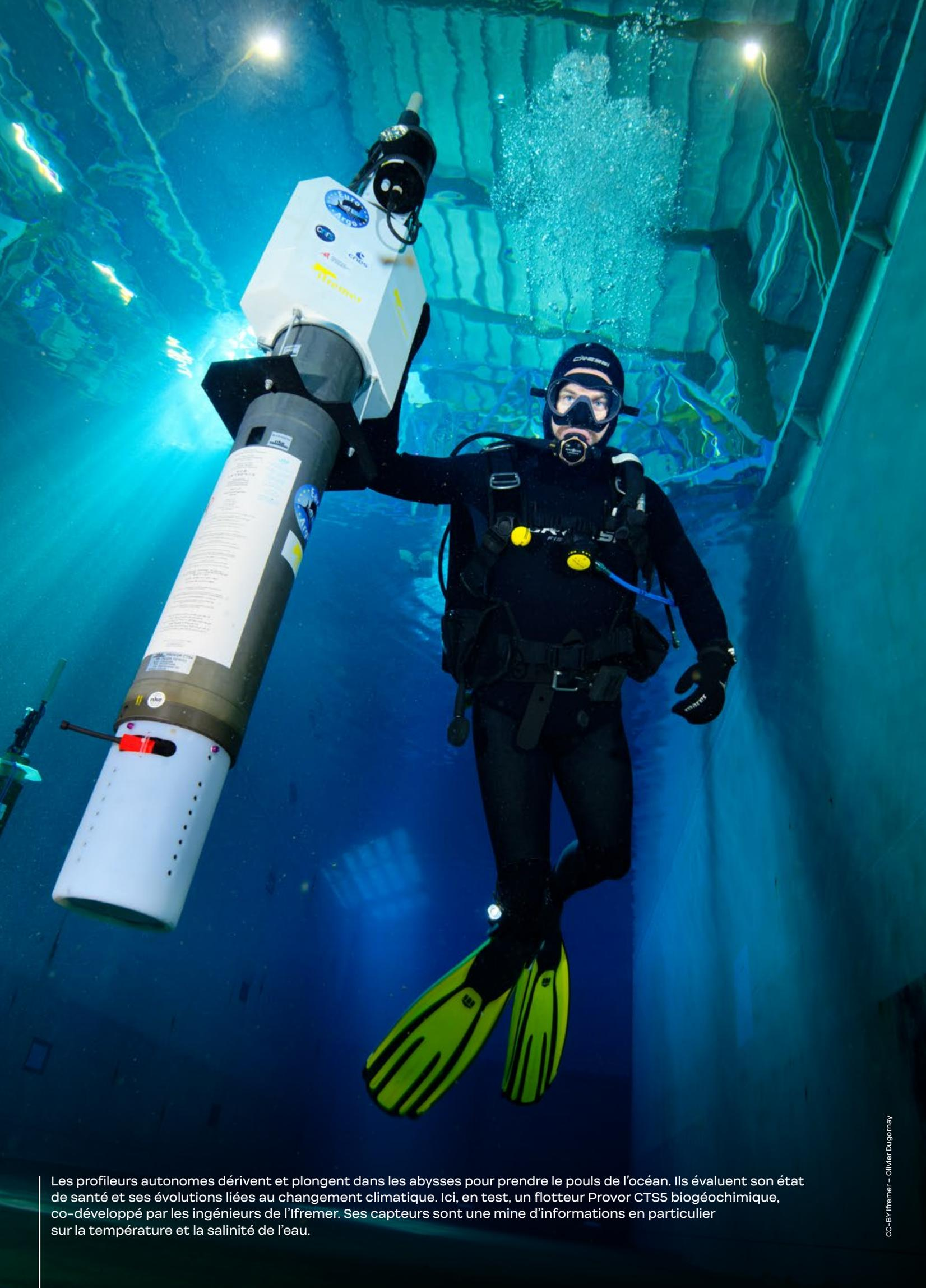
Les profileurs autonomes dérivent et plongent dans les abysses pour prendre le pouls de l'océan. Ils évaluent son état de santé et ses évolutions liées au changement climatique. Ici, en test, un flotteur Provor CTS5 biogéochimique, co-développé par les ingénieurs de l'Ifremer. Ses capteurs sont une mine d'informations en particulier sur la température et la salinité de l'eau.
