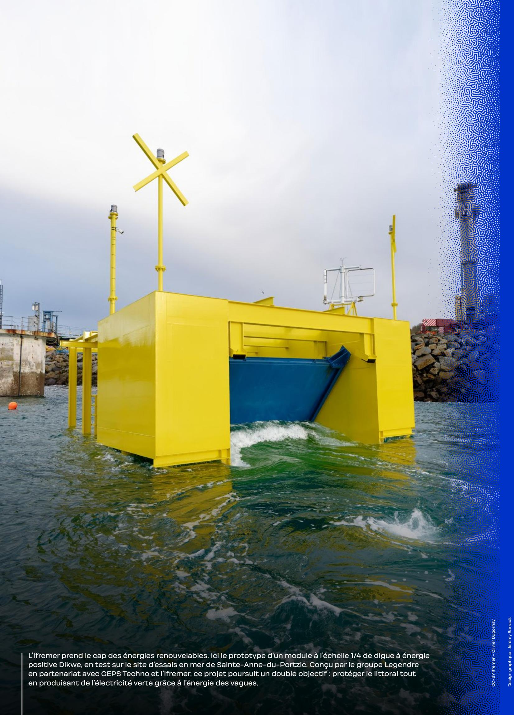
L'Ifremer prend le cap des énergies renouvelables. Ici le prototype d'un module à l'échelle 1/4 de digue à énergie positive Dikwe, en test sur le site d'essais en mer de Sainte-Anne-du-Portzic. Conçu par le groupe Legendre en partenariat avec GEPS Techno et l'Ifremer, ce projet poursuit un double objectif : protéger le littoral tout en produisant de l'électricité verte grâce à l'énergie des vagues.
