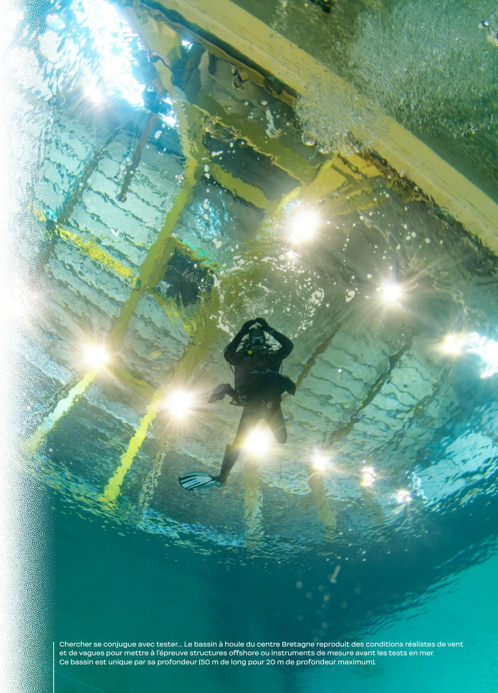
Chercher se conjugue avec tester... Le bassin à houle du centre Bretagne reproduit des conditions réalistes de vent et de vagues pour mettre à l'épreuve structures offshore ou instruments de mesure avant les tests en mer. Ce bassin est unique par sa profondeur (50 m de long pour 20 m de profondeur maximum).
