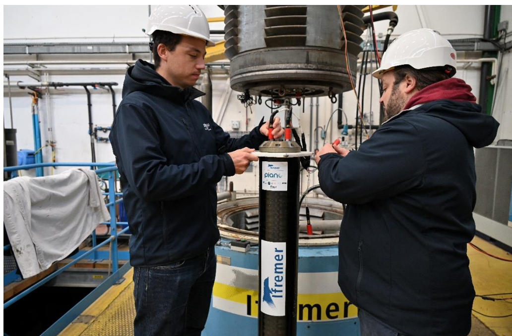
Pour s'assurer qu'ils peuvent plonger jusqu'à 6000 mètres de profondeur, les flotteurs Deep-Arvor sont testés dans les caissons hyperbares de l'Ifremer à Brest. – crédit Ifremer, Stéphane Lesbats
